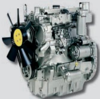
El motor Perkins 1104 C 44 – 4 cilindros de inyección directa ha sido elegido por sus prestaciones y por su fiabilidad. Desarrolla 84 cv/61.5 kW a un régimen nominal de 2.200 r.p.m y cumple la norma Euro 2. Además, la MC 30 incorpora una transmisión de convertidor de par y una caja de cambios de 4 marchas a elegir entre motricidad o velocidad de desplazamiento según la configuración de trabajo.
