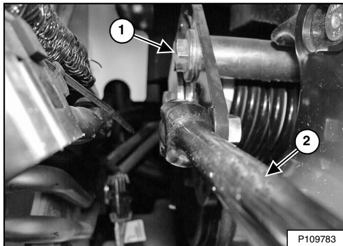
Afloje el perno que gradúa la polea tensora accionada con resorte (ítem 1). Inserte una barra (ítem 2) [Figura 267] en la ranura del brazo de tope, como se muestra, y empuje la barra hacia abajo para liberar la tensión en la correa de transmisión.
