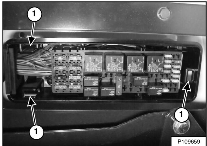
Alinee los ganchos detrás de la cubierta del panel de fusible con las ranuras (ítem 1) [Figura 231] en el panel de fusible y empuje la cubierta en su lugar cuando termine.
