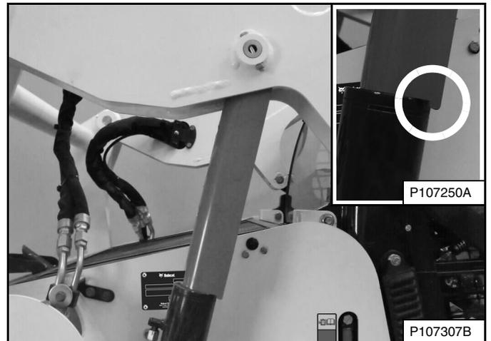
Baje los brazos de elevación lentamente hasta que el dispositivo de soporte quede sostenido entre los brazos y el cilindro de elevación. Las lengüetas del dispositivo de soporte del brazo deben atravesar la punta del cilindro (interior) [Figura 170].
