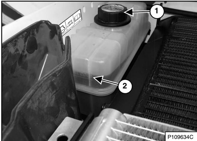
El refrigerante debe estar entre el indicador superior e inferior (ítem 2) [Figura 224] cuando el motor está frío.
