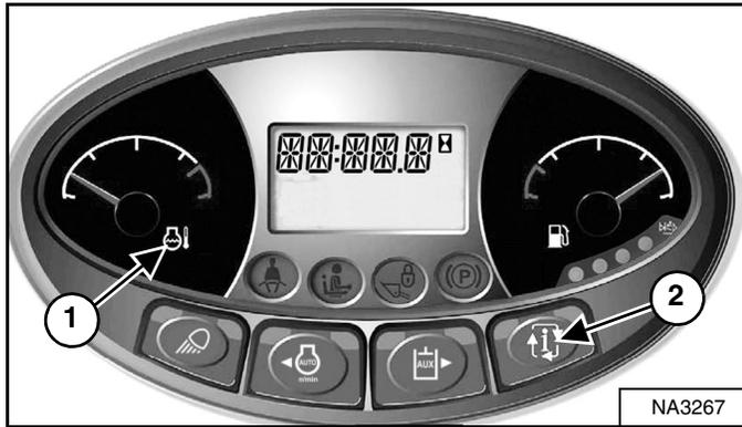
Monitoree frecuentemente los medidores de temperatura y combustible y las lámparas del BICS<sup>MR</sup> (todas las lámparas del BICS<sup>MR</sup> deben estar apagadas para operar el cargador) [Figura 133].
