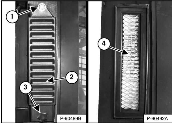
Los filtros de aire fresco se encuentran debajo de las ventanas laterales, por fuera de la cabina del operador. (Se muestra el filtro al lado derecho). Quite el tornillo de retención (ítem 3) y la tapa del filtro (ítem 2) [Figura 189]. (Los brazos de elevación se muestran levantados para describir el procedimiento con claridad).
