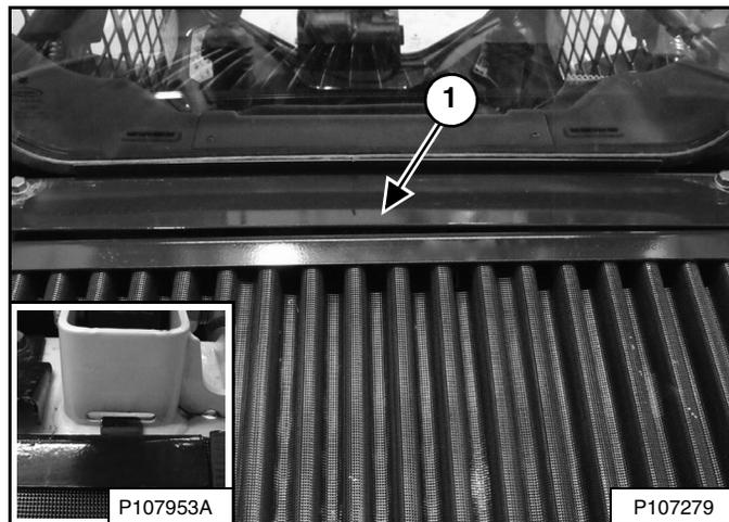
Alinee el borde de la rejilla posterior debajo del protector (ítem 1), inserte las lengüetas en las ranuras (se muestra el lado derecho) (interno) **[Figura 188]**, y descienda.
