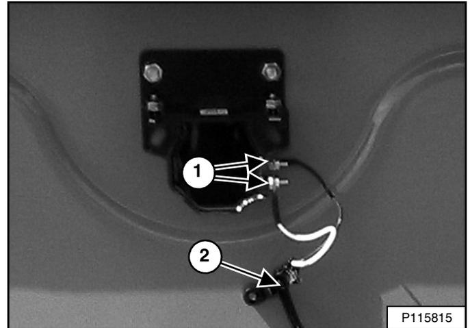
Inspeccione que las conexiones eléctricas (ítem 1) [Figura 174], arnés de cableado (ítem 2) [Figura 174] e interruptores (si están equipados) (ítem 1) [Figura 175] de la alarma está apretados y dañados. Repare o reponga los componentes dañados.
