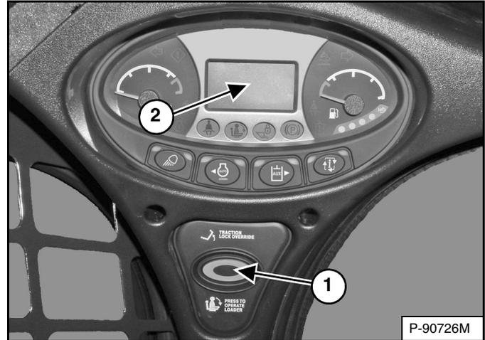
Oprima el botón PRESS TO OPERATE LOADER (ítem 1) [Figura 121] para activar el BICS<sup>MR</sup> y para usar las funciones hidráulicas y del cargador.
