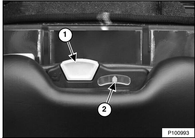
La palanca (ítem 1) se usa para ajustar la respuesta de la suspensión del asiento dependiendo del peso del operador. El ajuste óptimo se logra cuando la aguja (ítem 2) [Figura 111] está centrada en el medidor con el operador sentado normalmente.
