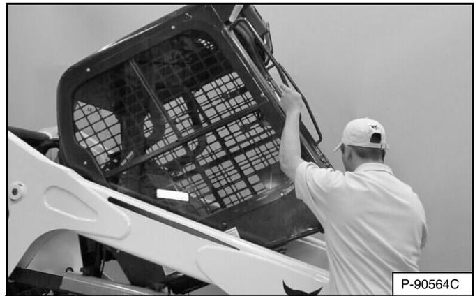
Suba las palancas de agarre y el extremo inferior de la cabina del operador [Figura 181] lentamente hasta que la cabina quede completamente arriba y el mecanismo de seguridad se enganche.
