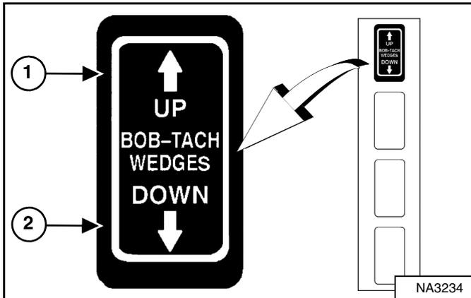
Empuje y sostenga el interruptor que "SUBE" LAS CUÑAS DEL BOB-TACH (ítem 1) hasta que suban del todo. Empuje y sostenga el interruptor que "BAJA" LAS CUÑAS DEL BOB-TACH (ítem 2) [Figura 287] hasta que bajen del todo.
