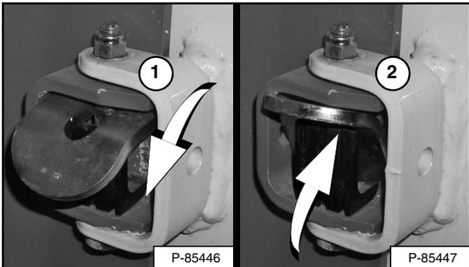
Mueva la traba de la compuerta a la posición enganchada (ítem 1) para mantener la compuerta abierta. Mueva la traba hacia arriba (ítem 2) [Figura 185] para permitir que la compuerta se cierre.
