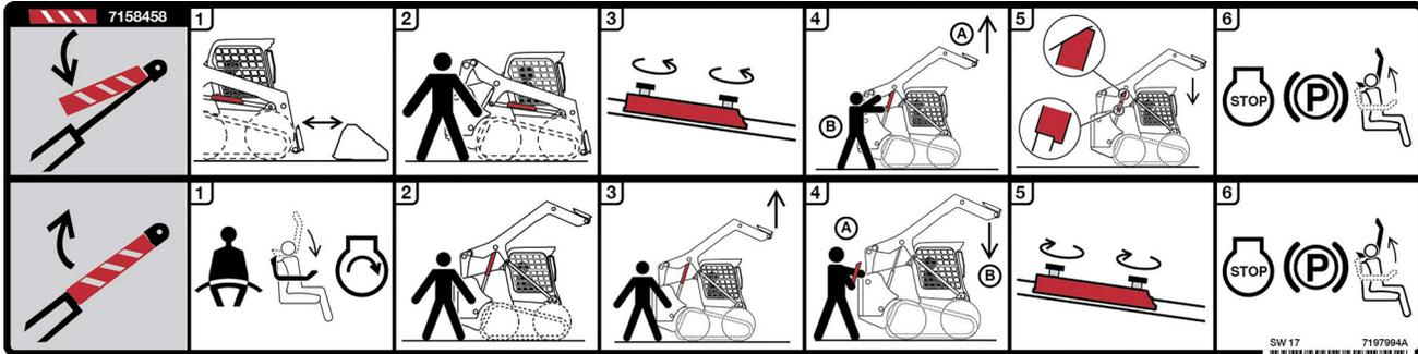
*Para instalar el soporte aprobado del brazo de elevación:*
