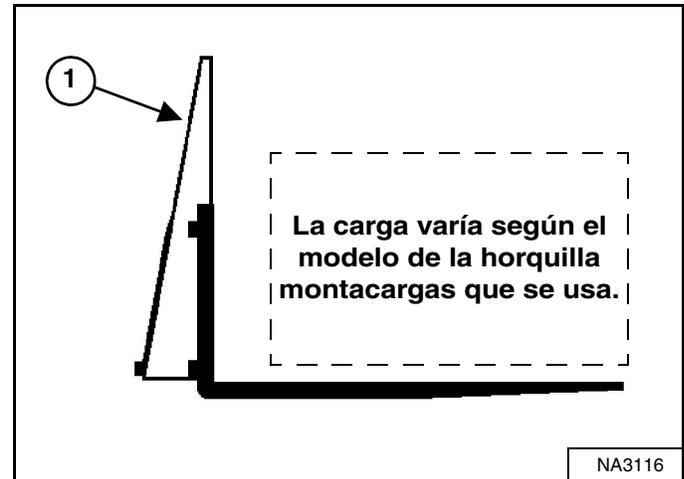
La máxima carga a transportar cuando se usa una horquilla montacargas se muestra en una calcomanía ubicada en el bastidor de dicha horquilla montacargas (ítem 1) [Figura 138].
