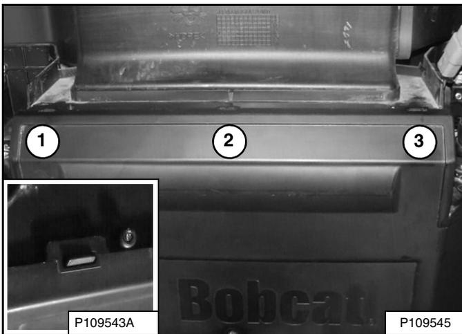
2. Empuje la cubierta hacia arriba tres lugares (ítem 1, 2 y 3) hasta que las ranuras se encajen en su lugar. Esta ranura (interior) [Figura 196] está ajustada correctamente.
