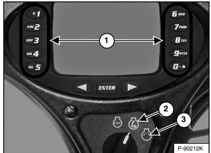
Gire el interruptor de llave a RUN (ítem 2). Las luces indicadoras en el panel de instrumentos izquierdo se ENCENDERÁN brevemente y el panel de instrumentos / sistema de monitoreo realizará una autopruueba. Use el teclado numérico (ítem 1) [Figura 128] para digitar la contraseña.
