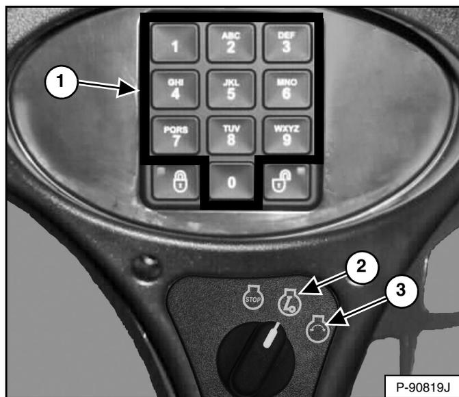
Gire el interruptor de llave a RUN (ítem 2). Las luces indicadoras en el panel de instrumentos izquierdo se ENCENDERÁN brevemente y el panel de instrumentos / sistema de monitoreo realizará una autoprueba. Use el teclado numérico (ítem 1) [Figura 123] para digitar la contraseña.
