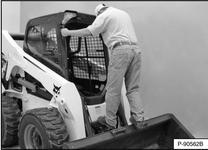
Use los escalas del cucharón o aditamento, las palancas de agarre y los peldaños de seguridad (en el brazo y el bastidor del cargador) para ingresar y salir del cargador, manteniendo 3 puntos de contacto todo el tiempo [Figura 105]. No salte.
