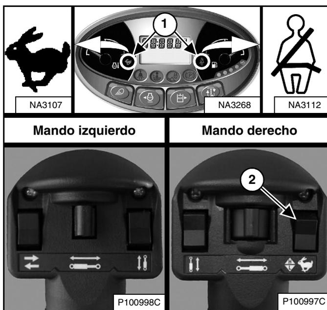
Para rango alto, oprima el extremo superior del interruptor (ítem 2) en el mando derecho. Los íconos del control de dos velocidades y del cinturón de hombro en el panel de instrumentos izquierdo (ítem 1) [Figura 66] se encienden.
