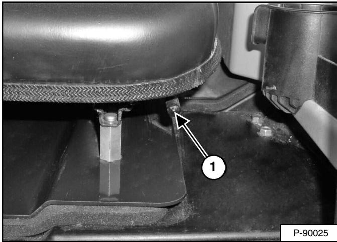
Tire de la palanca (ítem 1) [Figura 107] hacia afuera para ajustar la posición del asiento para operar los controles del cargador con comodidad.
