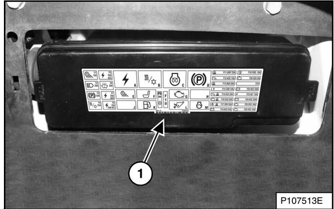
El sistema eléctrico está protegido de sobrecargas por los fusibles que están debajo de la cubierta del panel (ítem 1) [Figura 230]. Quite la tapa del panel de fusibles tirando de cada punta.
