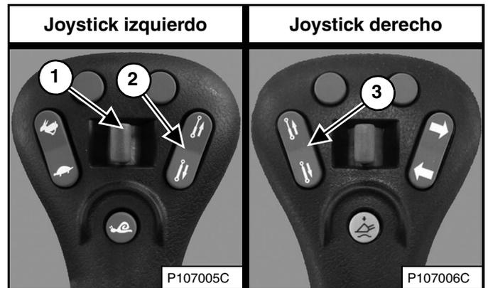
Los interruptores adicionales (ítem 1, 2 y 3) [Figura 102] o [Figura 103] se usan para controlar algunas funciones de los aditamentos a través del dispositivo de control.
