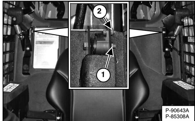
Use aire comprimido para limpiar escombros o suciedad de las piezas que hacen pivote. No lubrique. Inspeccione todo el herraje de fijación. La adecuada fuerza de torsión de la tuerca (ambos lados) (ítem 1) es 34 – 38 N•m (25 – 28 libras-pie). La fuerza de torsión o torque de la tuerca del sensor de la barra del asiento (solo al lado izquierdo) (ítem 2) [Figura 165] es 6 – 8 N•m (50 – 70 in-lb).
