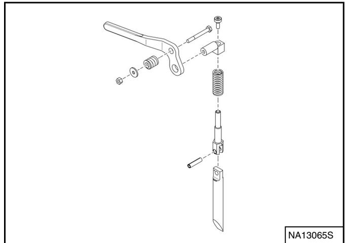
Inspeccione en los acoplamientos y cuñas del bastidor de fijación del aditamento y el Bob-Tach la presencia de desgaste excesivo o daños [Figura 286]. Reponga las partes que están dañadas, golpeadas o que faltan. Mantenga todos los sujetadores apretados.
