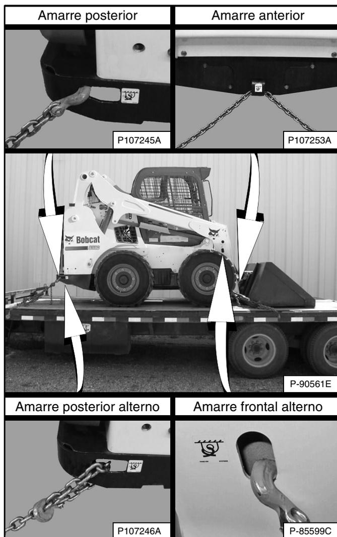
Ejecute el siguiente procedimiento para sujetar el cargador Bobcat al vehículo de transporte con el fin de evitar que el cargador se mueva durante paros repentinos o al subir o bajar pendientes [Figura 162].
