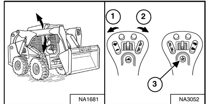
*Operación del brazo de elevación – (joystick manual izquierdo)*
