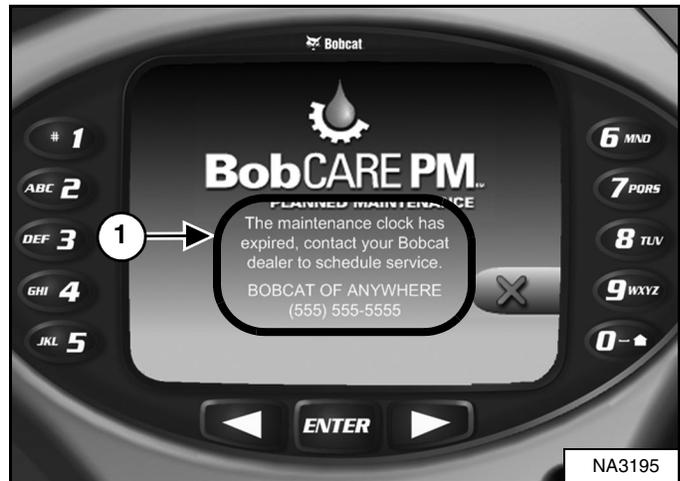
El panel de instrumentos de lujo (si está equipado) muestra un mensaje (ítem 1) [Figura 295] que alerta al operador dar servicio a la máquina.
