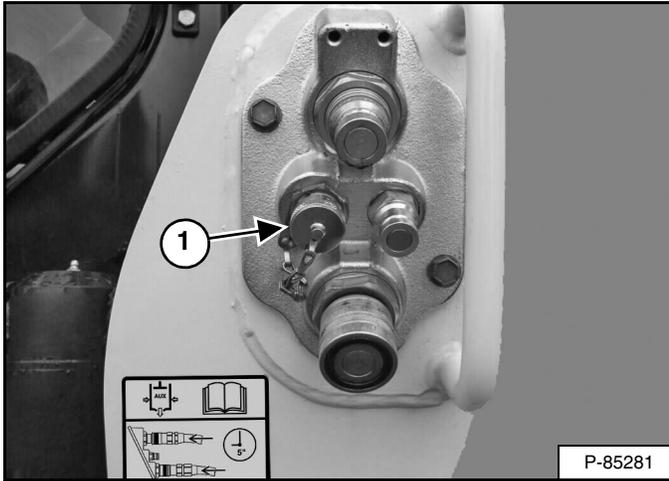
Conecte el arnés de cableado eléctrico del aditamento con el dispositivo de control (ítem 1) [Figura 100].
