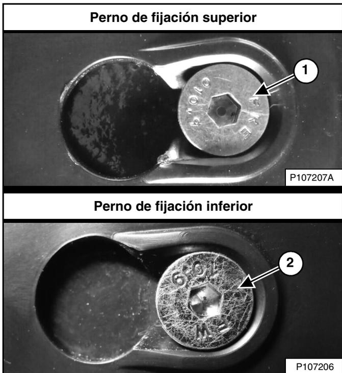
Coloque el protector de la correa de transmisión sobre los pernos de fijación y deslice el protector hacia el frente del cargador para sentar el protector completamente en los pernos de fijación superior e inferior (ítem 1 y 2) [Figura 269].
