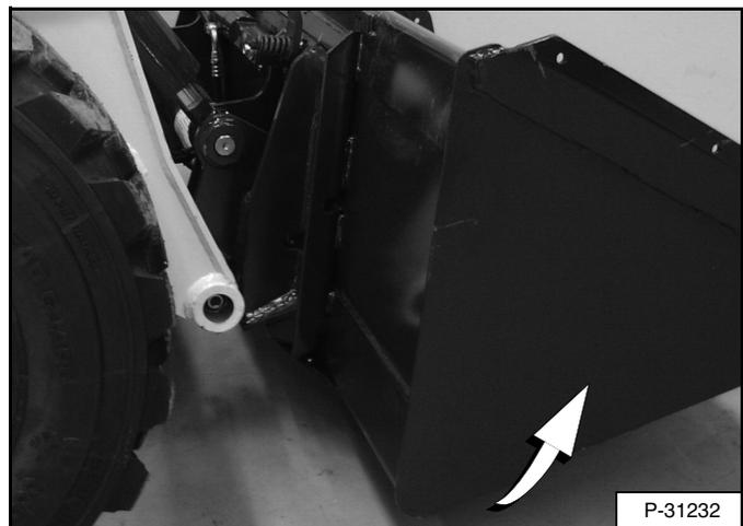
Incline el Bob-Tach hacia atrás hasta que el borde cortante del cucharón (u otro aditamento) quede un poco levantado del suelo [Figura 148]. Esto hace que el bastidor de fijación del cucharón se ajuste contra el frente del enganche rápido (Bob-Tach).
