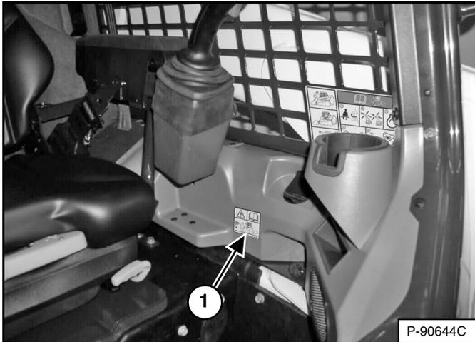
Inspeccione que la calcomanía de la alarma de alerta de reversa no esté dañada o falte (ítem 1) [Figura 173]. Repóngala, si es del caso.
