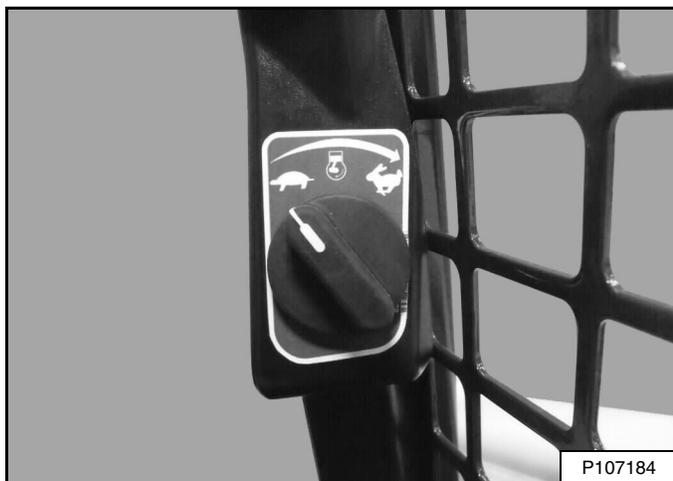
Coloque el control del motor en la posición de velocidad en ralentí baja (vacío) [Figura 122].
