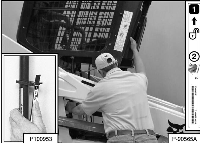
Tire hacia abajo el extremo inferior de la cabina del operador hasta que ésta se detenga en el mecanismo de seguridad [Figura 182].
