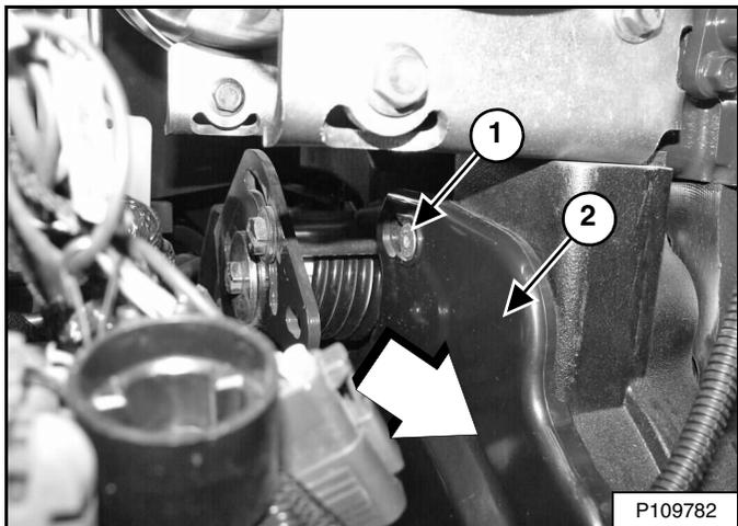
**NO** afloje los pernos del protector de la correa de transmisión (se muestra el perno superior) (ítem 1). Deslice el protector (ítem 2) [Figura 266] hacia el lado posterior del cargador para desasentarlo de los pernos de fijación superior e inferior de la correa.
