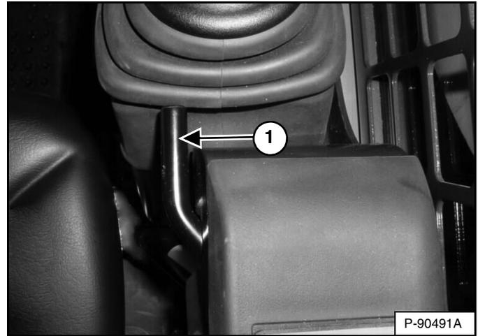
Para trabajar con comodidad, tire de la palanca de ajuste (ítem 1) [Figura 116] hacia arriba para deslizar el joystick del cargador hacia adelante o atrás. (Se muestra el lado derecho).
