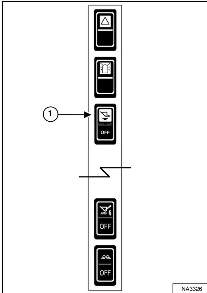
Oprima la punta superior del interruptor (ítem 1) **[Figura 82]** en el panel izquierdo para activar la función del posicionamiento del cucharón. La lámpara ámbar del interruptor se ENCIENDE.
