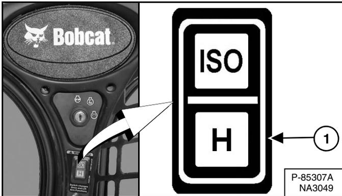
Elija el patrón de control 'H' oprimiendo el extremo inferior del interruptor (ítem 1) [Figura 62].
