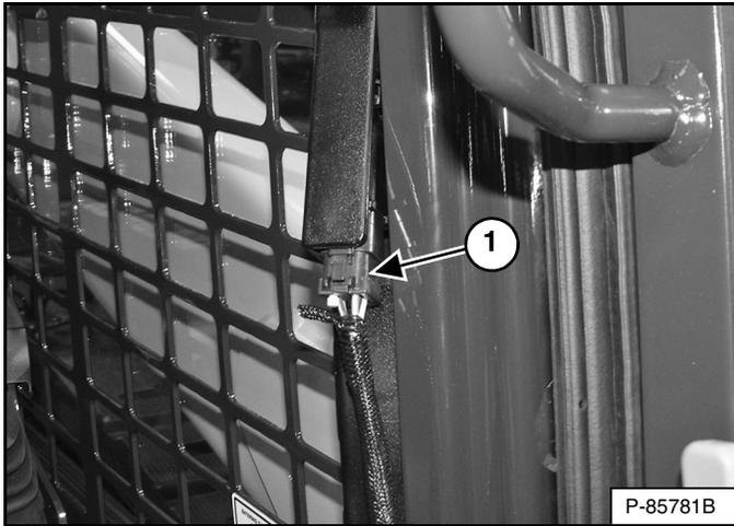
Desconecte el conector eléctrico (ítem 1) [Figura 52].
