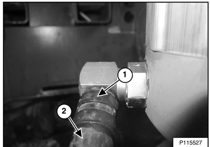
Quite la mordaza (ítem 1). Tome la manguera (ítem 2) [Figura 245] cerca del accesorio y desconecte la manguera del accesorio. Coloque la manguera hacia el exterior del cargador y drene el fluido en un recipiente.
