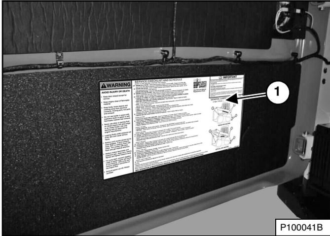
La lista de chequeo y mantenimiento (ítem 1) [Figura 104] está al interior de la compuerta trasera del cargador.
