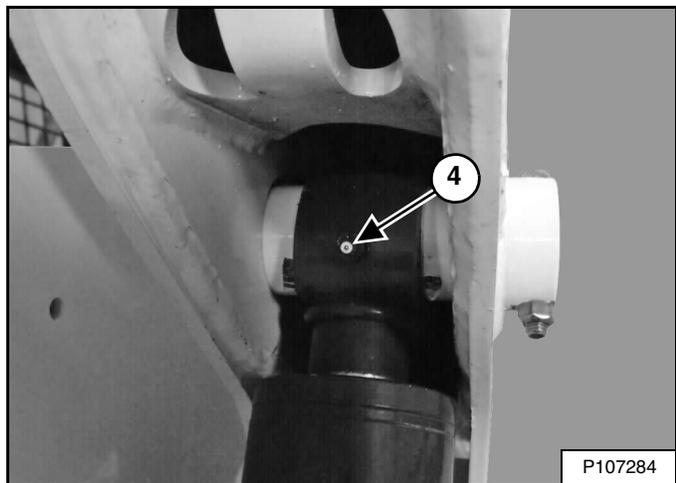
4. Punta de la biela del cilindro de elevación (ambos lados) (2) [Figura 275].
