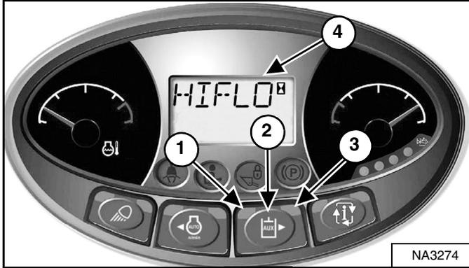
Oprima el botón (ítem 2) una vez para activar los hidráulicos auxiliares. La lámpara (ítem 1) **[Figura 95]** se ENCIENDE.
