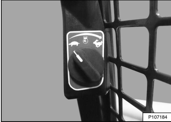
Coloque el control del motor en la posición de velocidad en ralentí baja (vacío) [Figura 134].
