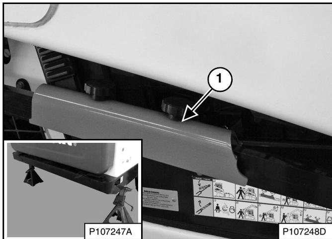
Coloque soportes debajo de las esquinas posteriores del bastidor del cargador (interior) [Figura 168].
