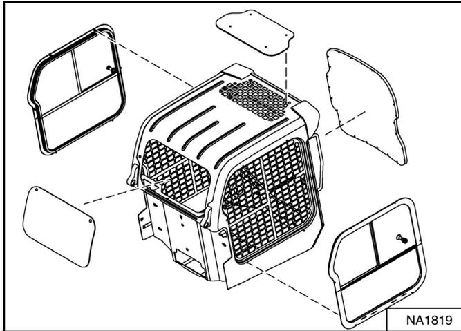
Disponible para aplicaciones especiales para evitar el ingreso de escombros que vuelan y objetos a la cabina. El kit incluye una puerta delantera de policarbonato, ventanas laterales y ventana posterior de policarbonato laminados de 19,1 mm (0.75 pulgadas) de espesor [Figura 5].
