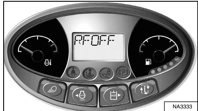
El ventilador inverso se deshabilita cuando el refrigerante o fluido hidráulico del motor tiene una temperatura demasiado alta o demasiado baja.
