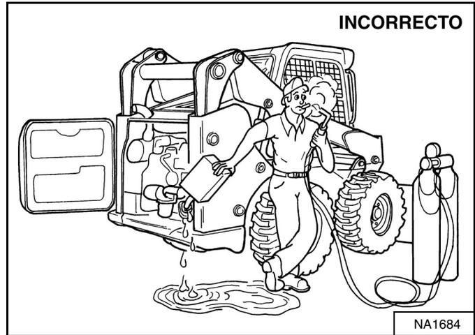
Use un recipiente limpio y aprobado para agregar el combustible especificado. Solo abastezca el tanque en un área que tenga un movimiento libre de aire y sin llamas abiertas o chispas. **NO FUME** [Figura 204].
