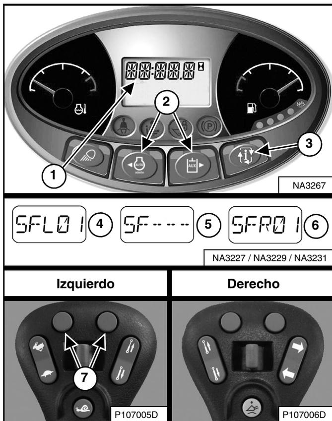
Oprima el botón de información (ítem 3) para activar la pantalla de datos hasta que aparezca el menú de la compensación de deriva de la dirección. El ajuste actual de la compensación aparece en la pantalla de datos (ítem 1) [Figura 74].
