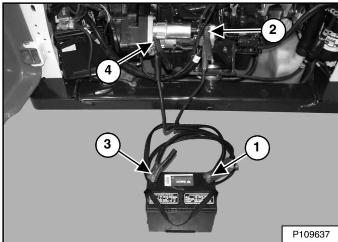
Conecte la punta del primer cable (ítem 1) en el borne positivo (+) de la batería de refuerzo. Conecte la otra punta del mismo cable (ítem 2) [Figura 237] con el borne positivo (+) del arrancador del cargador.
