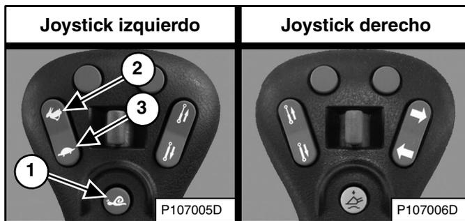
Ajuste un porcentaje de velocidad mayor (ítem 2) o menor (ítem 3) [Figura 70] oprimiendo el interruptor de control de velocidad hasta que aparezca el ajuste por defecto que desea.
