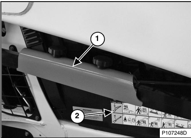
El dispositivo de soporte del brazo de elevación (ítem 1) [Figura 167] se usa para apoyar los brazos de elevación mientras trabaja en una máquina con los brazos arriba.
