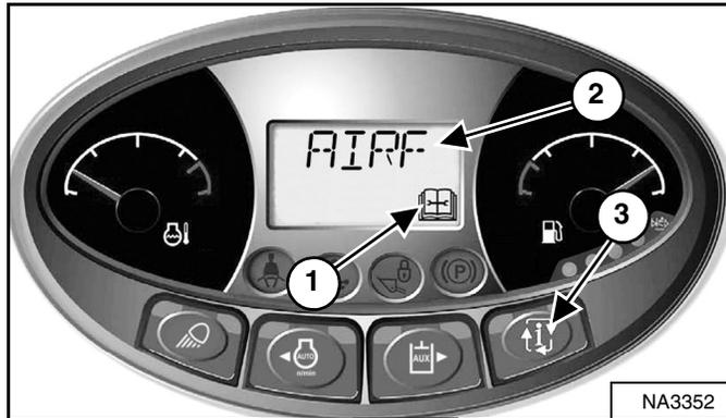
Reemplace los filtros de aire solo cuando sea necesario. El indicador de servicio (ítem 1) DESTELLA. Oprima el botón de información (ítem 3) hasta que la pantalla muestre los códigos de diagnóstico. Los códigos [AIRF] (reemplace el filtro de aire del motor) o [M0117] (filtro de aire tupido) aparecen en la pantalla (ítem 2) [Figura 198] cuando el filtro de aire se debe cambiar.
