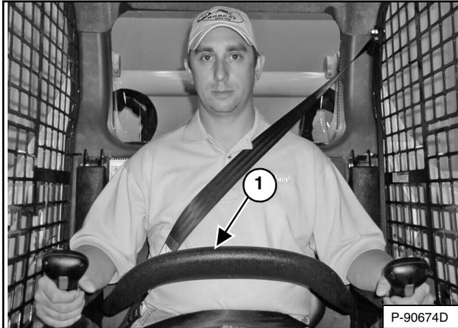
El sistema de restricción del asiento tiene una barra del asiento que hace pivote con descansabrazos (ítem 1) [Figura 164].
