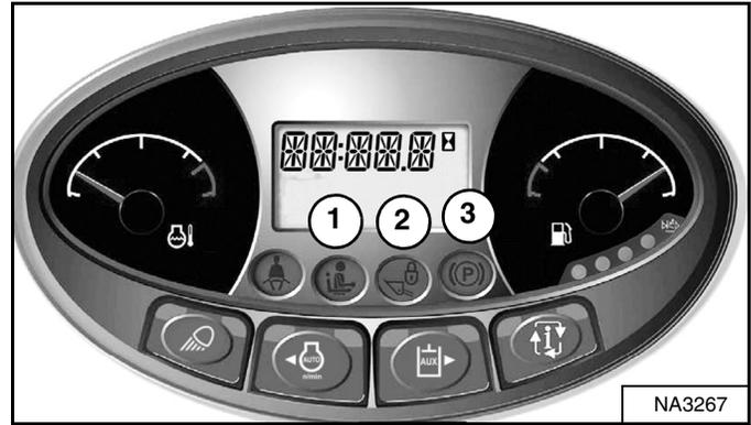
Hay tres lámparas (ítem 1, 2 y 3) [Figura 35] ubicadas en el panel de instrumentos izquierdo que deben estar APAGADAS para operar la máquina plenamente.
