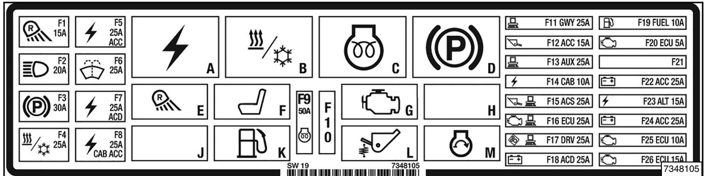
**SJC** - la ubicación y los niveles de amperios se muestran en la tabla de abajo y en la calcomanía **[Figura 233]**. Los relés o disyuntores se identifican con la letra "R" en la columna AMP.
