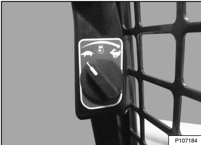
Coloque el control del motor en la posición de velocidad en ralentí baja (vacío) [Figura 117].
