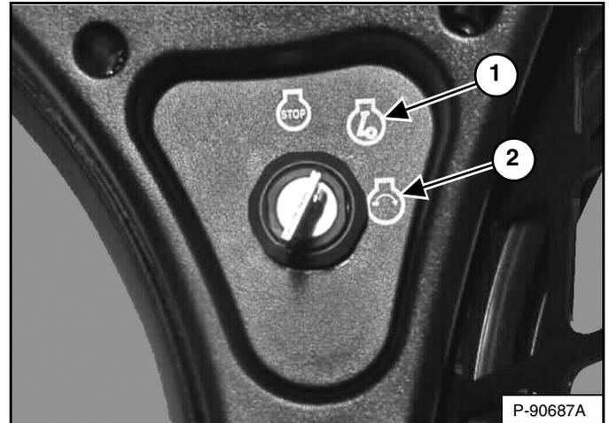
Gire el interruptor a RUN (ítem 1) [Figura 118]. Las luces indicadoras en el panel de instrumentos izquierdo se ENCENDERÁN brevemente y el panel de instrumentos / sistema de monitoreo realizará una autoprueba.
