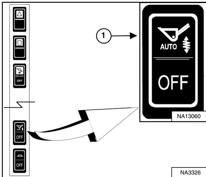
Oprima el extremo superior del interruptor (ítem 1) [Figura 83] en el panel izquierdo para habilitar la función del control de viaje automático.
