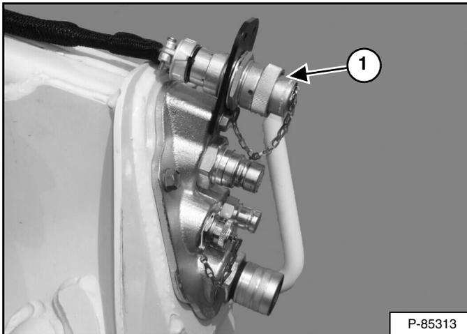
Se necesita el kit del dispositivo de control de aditamentos de 14 pasadores (ítem 1) [Figura 101] para operar los aditamentos de modelos anteriores. Comuníquese con el distribuidor de su cargador Bobcat.
