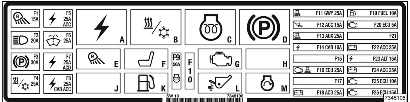
**Controles estándar** - la ubicación y los niveles de amperios se muestran en la tabla de abajo y en la calcomanía [Figura 232]. Los relés o disyuntores se identifican con la letra "R" en la columna AMP.
