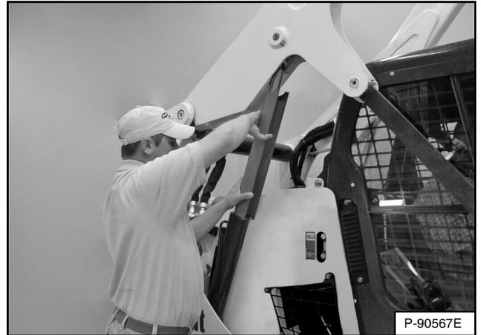
Una segunda persona debe instalar el dispositivo de soporte del brazo de elevación sobre la biela de uno de los cilindros de elevación [Figura 169].
