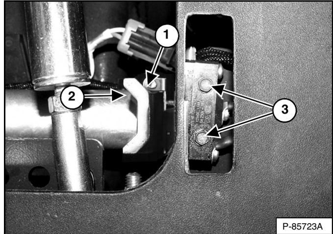
Afloje los tornillos (ítem 3) [Figura 176] que aseguran el interruptor de la alarma de reversa. (Se muestra el lado izquierdo).
