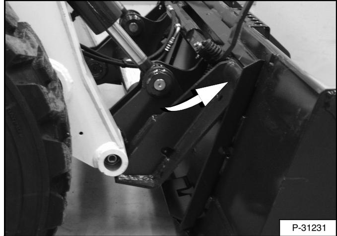
Maneje el cargador lentamente hacia adelante hasta que el borde superior del Bob-Tach quede completamente debajo de la pestaña superior del bastidor de fijación del cucharón [Figura 147] (o de otro aditamento).
