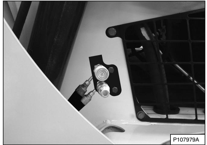
Mueva el interruptor de los hidráulicos auxiliares traseros (ítem 1) [Figura 92] o [Figura 93] hacia la derecha o izquierda para cambiar la dirección del caudal del fluido hidráulico auxiliar hacia los acoples rápidos traseros [Figura 94]. (POR EJEMPLO: subir y bajar estabilizadores traseros). Suelte el interruptor para detener el caudal del fluido.
