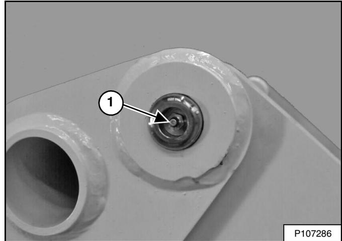
1. Pin de pivote del brazo de elevación (ambos lados) (2) [Figura 272].
