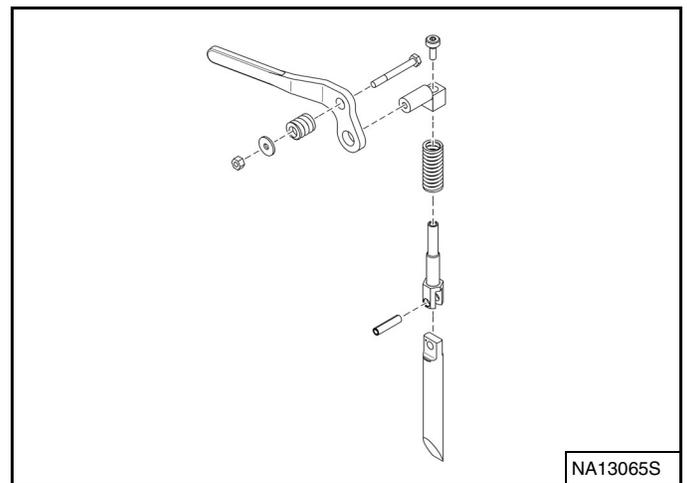
Inspeccione en los acoplamientos y cuñas del bastidor de fijación del aditamento y el Bob-Tach la presencia de desgaste excesivo o daños [Figura 289]. Reponga las partes que están dañadas, golpeadas o que faltan. Mantenga todos los sujetadores apretados.
