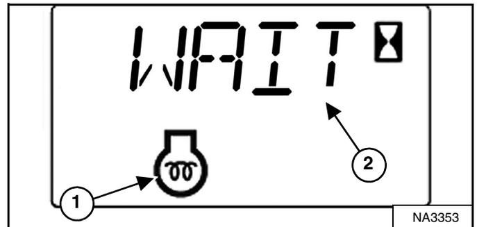
La máquina activa las bujías precalentadoras automáticamente con base en la temperatura. El ícono de precalentamiento del motor (ítem 1) y el tiempo restante del ciclo o [WAIT] (ítem 2) [Figura 129] aparece en la pantalla de datos.
