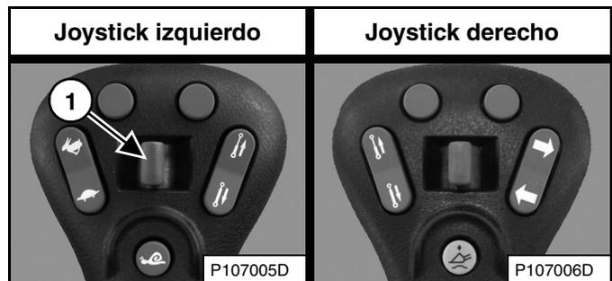
Mueva el interruptor de los hidráulicos auxiliares traseros (ítem 1) [Figura 98] o [Figura 99] hacia la izquierda y derecha varias veces. Gire el interruptor de llave a STOP.
