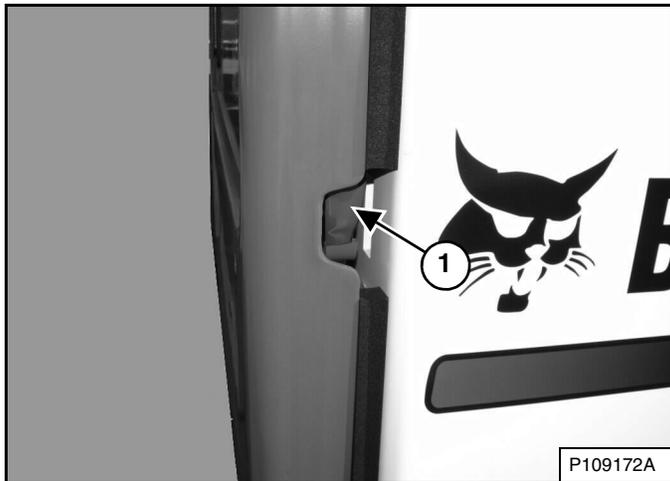
Alcance dentro de la ranura al lado derecho de la compuerta trasera y tire del mando de seguridad (ítem 1) [Figura 184]. Empuje la compuerta para abrirla.
