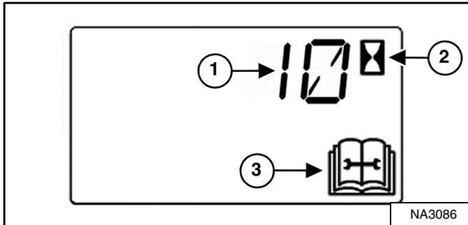
Durante la operación de la máquina, una alarma de dos señales sonará cuando restan menos de 10 horas para el siguiente mantenimiento planeado.
