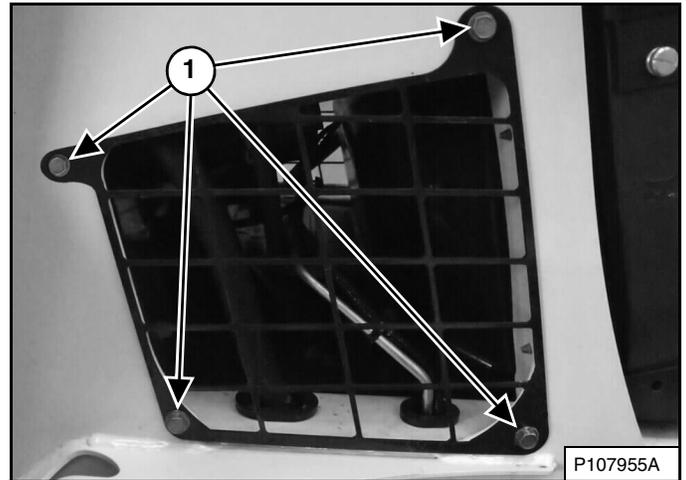
Quite los pernos en la cubierta de acceso a mano derecha (ítem 1) [Figura 244] y quite la cubierta. (Los brazos de elevación se muestran levantados para describir el procedimiento con claridad).
