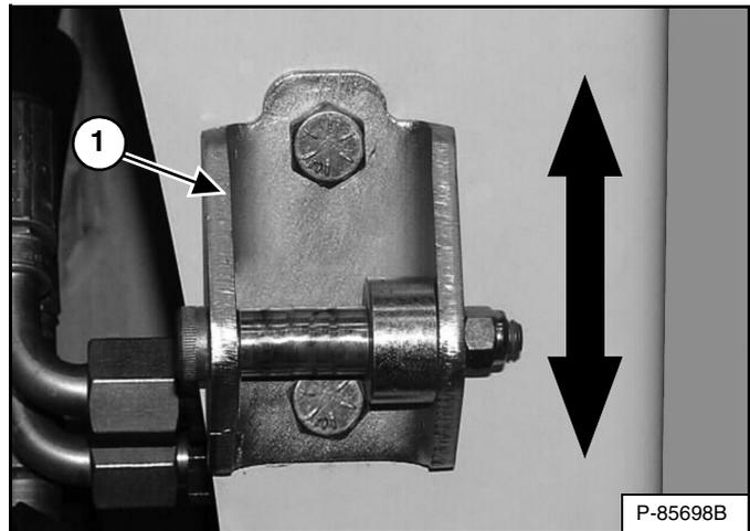
El cerrojo de la compuerta (ítem 1) [Figura 186] se puede ajustar hacia arriba o abajo para alinearlos con el cerrojo de la compuerta.
