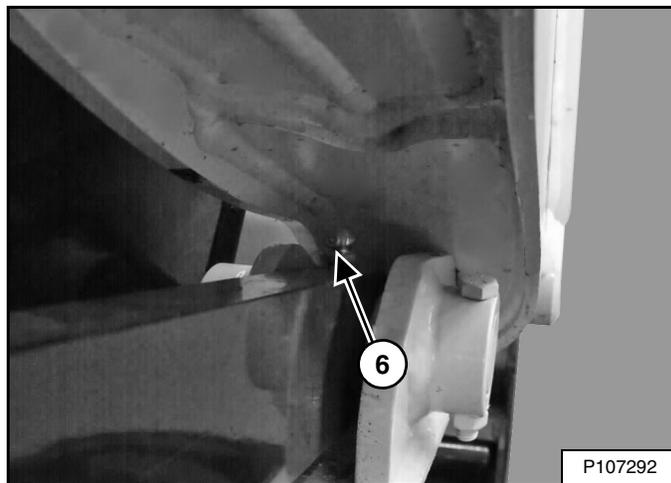
6. Acoplamiento de control delantero (ambos lados) (2) [Figura 277].
