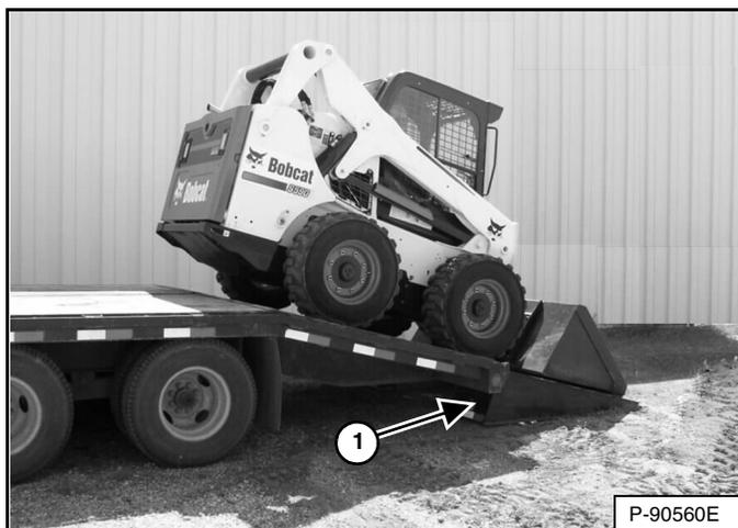
Un cargador con un cucharón vacío o sin aditamento debe cargarse en reversa sobre el vehículo de transporte [Figura 161].
