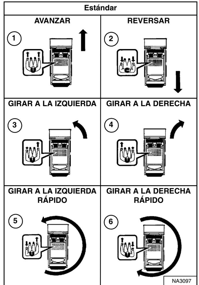
Funciones de la palanca de dirección (manejo y dirección) [Figura 58]:
