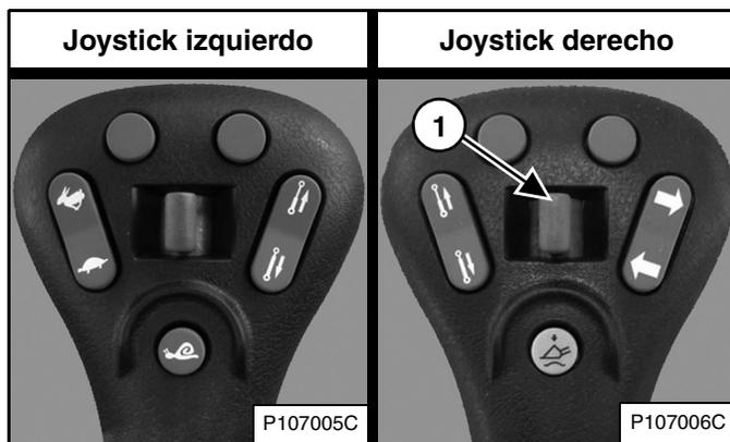
Mueva el interruptor de los hidráulicos auxiliares delanteros (ítem 1) [Figura 87] o [Figura 88] hacia la derecha o izquierda para cambiar la dirección del caudal del fluido hidráulico auxiliar hacia los acoples rápidos delanteros. Si mueve el interruptor hacia la mitad, las funciones auxiliares se mueven aproximadamente a media velocidad. (POR EJEMPLO: abrir y cerrar dientes de grapa).
