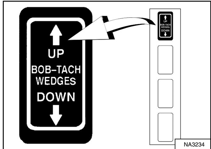
Oprima y sostenga el interruptor que “SUBE” LAS CUÑAS del BOB-TACH (en el panel de interruptores a mano derecha) [Figura 152] hasta que las palancas queden arriba del todo (cuñas completamente levantadas).
