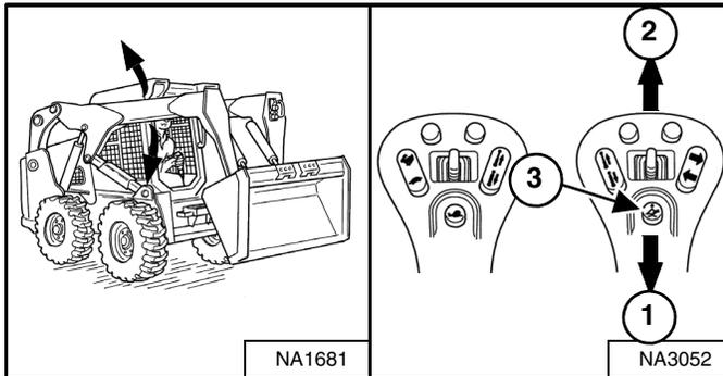
*Operación del brazo de elevación – (joystick manual derecho)*
