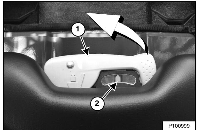
La palanca (ítem 1) se usa para ajustar la respuesta de la suspensión del asiento dependiendo del peso del operador. El ajuste óptimo se logra cuando la aguja (ítem 2) [Figura 109] está centrada en el medidor con el operador sentado normalmente.
