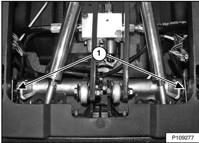
Los interruptores de la alarma de reversa (ítem 1) [Figura 175] están a lo largo de los balancines de la dirección. Ambos interruptores se deben graduar bien para que la alarma funcione correctamente.
