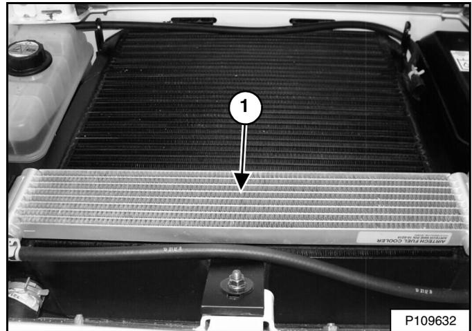
Use aire o agua a baja presión para limpiar la parte superior del refrigerante de combustible (ítem 1) [Figura 218].
