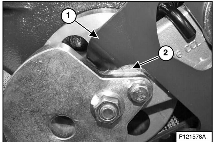
Permita que el brazo del tope (ítem 1) haga contacto con la parte superior del brazo del tensionador accionado con resorte (ítem 2) [Figura 264].
