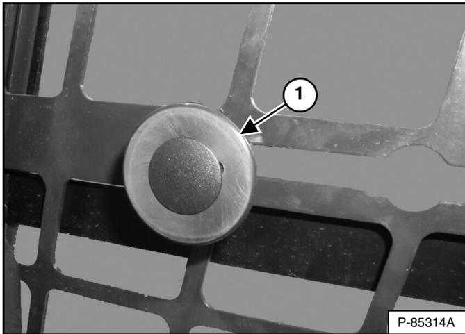
Tire de la perilla (ítem 1) [Figura 28] y deslícela hacia atrás para abrir la ventana. Suelte la perilla para asegurarla en la posición deseada. Tire de la perilla y deslícela hacia adelante para cerrar la ventana.
