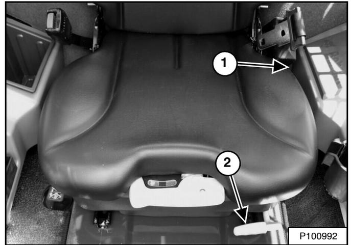
Tire de la palanca (ítem 1) [Figura 108] hacia arriba para ajustar el ángulo del espaldar del asiento.
