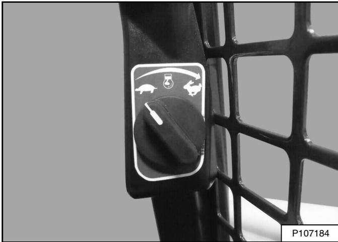
Coloque el control del motor en la posición de velocidad en ralentí baja (vacío) [Figura 127].
