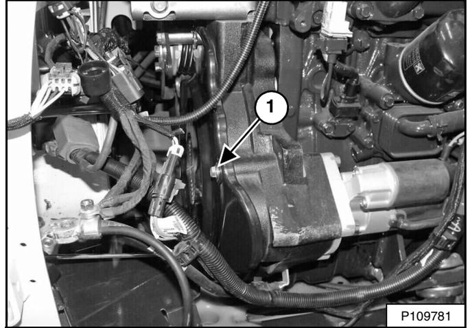
Instale el perno del protector de la correa de transmisión (ítem 1) [Figura 270].
