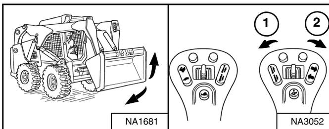
*Operación de inclinación – (joystick manual derecho)*
