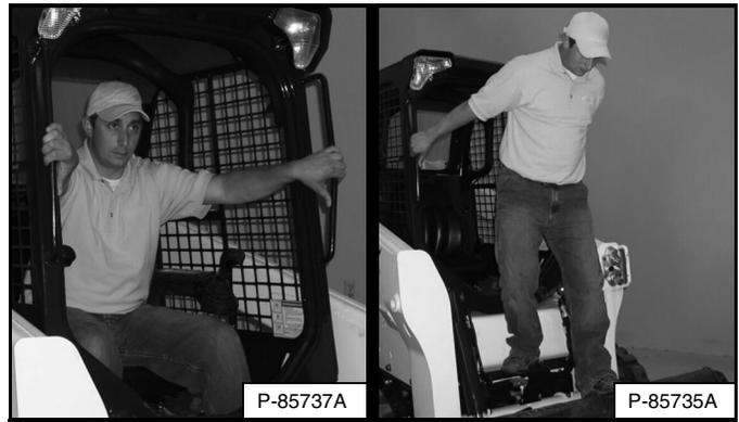
Salga del cargador usando las palancas de agarre, los peldaños de seguridad y los escalas (mantenga un contacto de tres puntos) [Figura 136].
