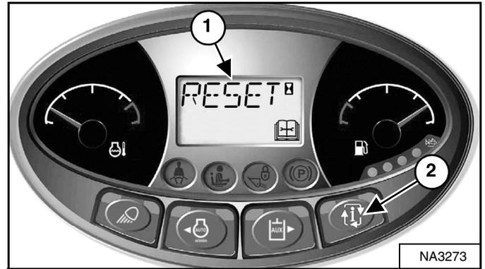
Oprima el botón de información (ítem 2) [Figura 297] hasta que la pantalla muestre el reloj de mantenimiento.
