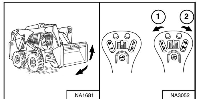
*Operación de inclinación – (joystick manual derecho)*
