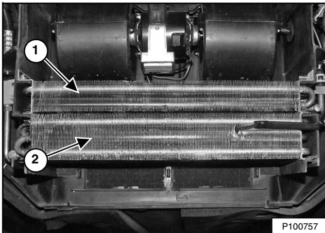
Use aire o agua a baja presión para quitar la suciedad de la bobina de calefacción (ítem 1) y del evaporador (ítem 2) [Figura 192].
