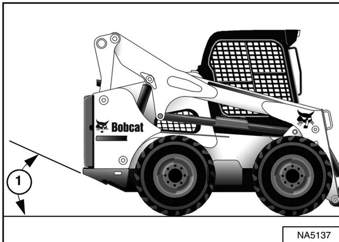
**NOTA:** El cargador se debe elevar lo más cerca del eje horizontal posible, pero el ángulo del cargador suspendido nunca debe exceder el ángulo de desviación (ítem 1) [Figura 159] que aparece en la sección de Especificaciones. (Ver Dimensiones de la máquina en la página 211).
