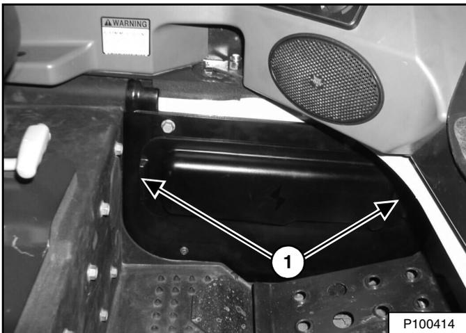
El panel de fusible y relé está detrás de un tablero de acceso cerca del pedal izquierdo o descansa pies. Tire de cada punta del panel (ítem 1) [Figura 229] para quitarlo.
