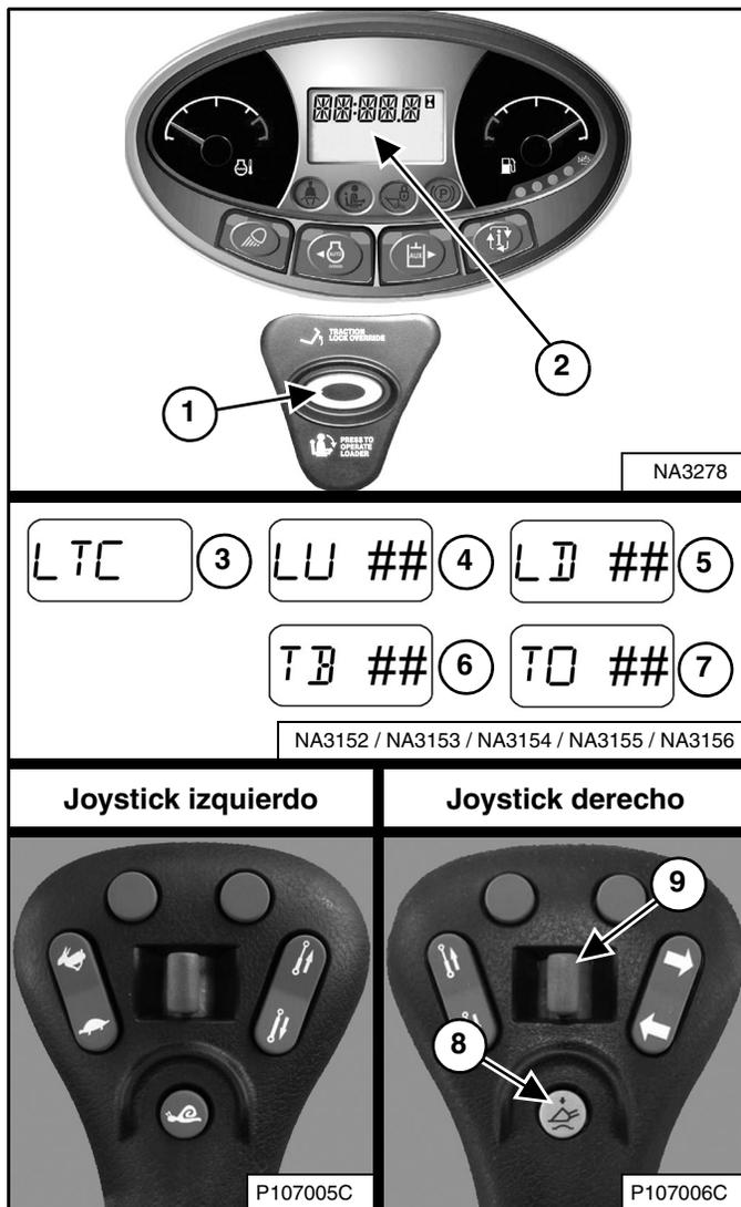
LTC – Compensación de elevación e inclinación
