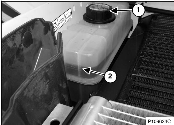
Agregue refrigerante premezclado (47% de agua y 53% de propilenglicol) al tanque hasta que el nivel de refrigerante alcance el marcador de nivel más bajo del tanque (ítem 2) [Figura 227].
