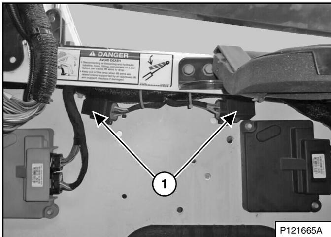
Los dos relés adicionales (ítem 1) [Figura 234] para las luces delanteras están ubicados debajo de la cabina del operador, al lado izquierdo del cargador. Detenga el motor y suba la cabina del operador para tener acceso a los relés. (Ver Cómo subir la cabina en la página 132).
