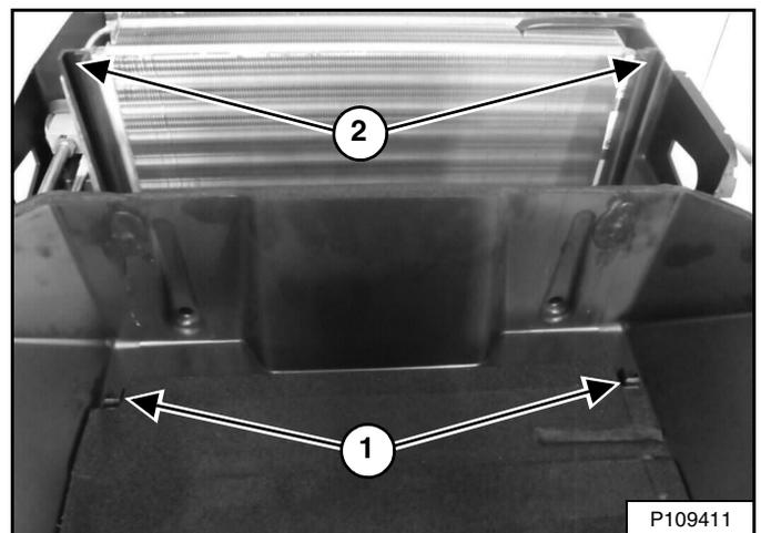
**NOTA:** Los bujes (ítem 1) caben dentro de los soportes (ítem 2) [Figura 194] cuando la cubierta está instalada. Una cubierta deforme indica que no están bien colocados.
