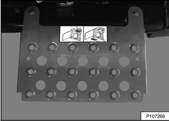
Hay una plataforma de mantenimiento [Figura 217] disponible donde su distribuidor Bobcat que facilita el acceso cuando se limpia el sistema de refrigeración del motor.
