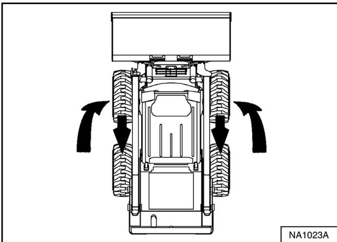
Las llantas traseras se desgastan generalmente más rápido que las delanteras. Para mantener un desgaste parejo, pase las llantas delanteras para atrás y las llantas traseras para adelante [Figura 253].
