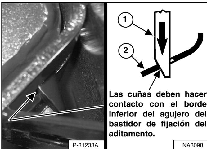
Las cuñas (ítem 1) [Figura 288] deben atravesar los agujeros en el bastidor de fijación del aditamento.
