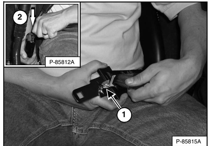
Conecte el cinturón de hombro con el cinturón de la cadera (ítem 1). Tire del cinturón de cadera hacia el lado derecho del asiento y abróchelo (ítem 2) [Figura 114].
