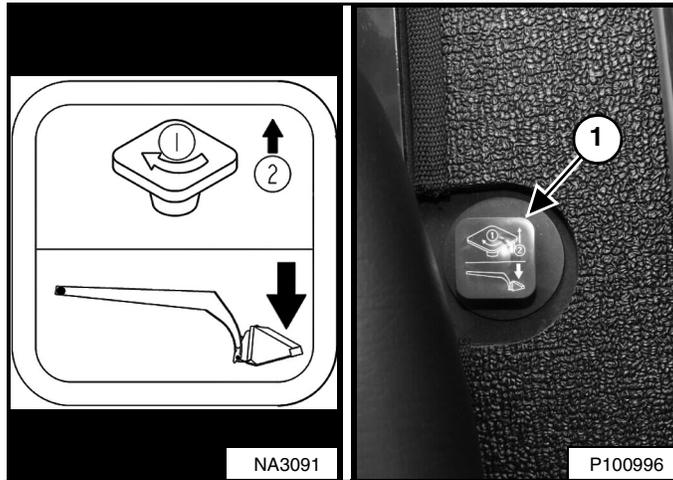
El control de deriva (ítem 1) [Figura 42], ubicado al lado derecho del asiento del operador, se usa para bajar el brazo si no es posible hacerlo durante operaciones normales.
