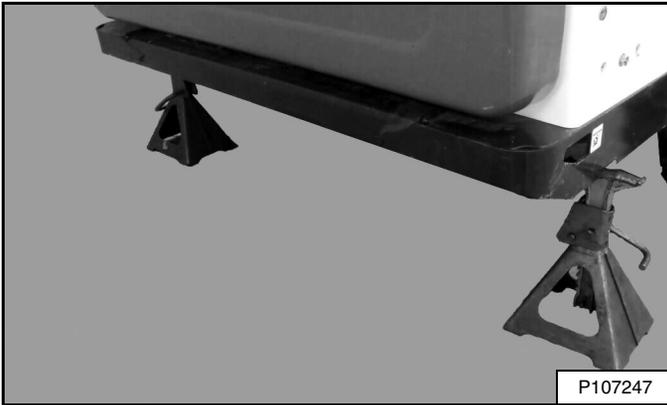
Instale los soportes debajo del extremo posterior del bastidor del cargador [Figura 179].
