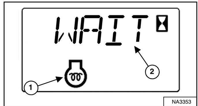
La máquina activa las bujías precalentadoras automáticamente con base en la temperatura. El ícono de precalentamiento del motor (ítem 1) y el tiempo restante del ciclo o [WAIT] (ítem 2) [Figura 119] aparece en la pantalla de datos.
