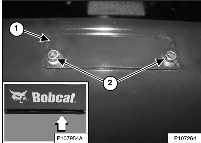
La manguera de drenaje de aceite está detrás de una tapa (ítem 1), debajo de la parte trasera del cargador (interior) [Figura 213].
