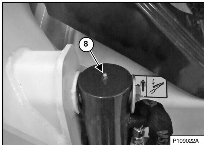
8. Punta de la base del cilindro de inclinación (ambos lados) (2) [Figura 279].
