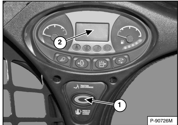
Oprima el botón PRESS TO OPERATE LOADER (ítem 1) [Figura 126] para activar el BICS<sup>MR</sup> y para usar las funciones hidráulicas y del cargador.
