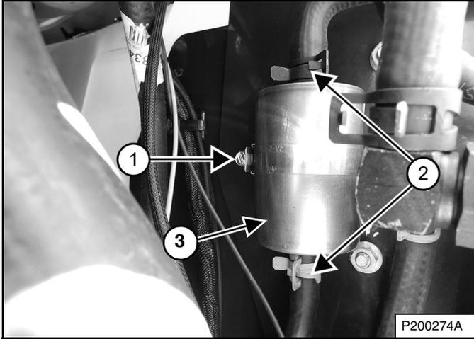
Apriete las dos manguera para evitar que el combustible se derrame mientras las mangueras se desconectan del pre-filtro (ítem 3) [Figura 206].
