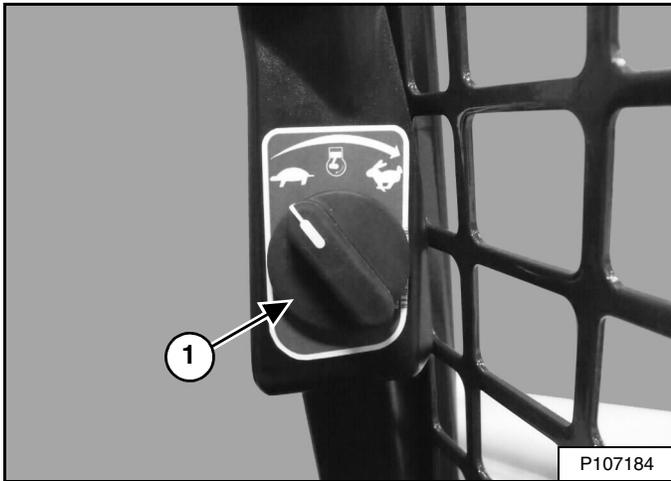
El control de velocidad del motor (ítem 1) [Figura 39] está junto al marco de la puerta, debajo del panel a mano derecha.
