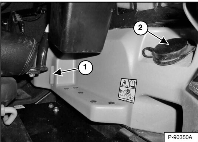
El tanque del líquido limpiador está al lado izquierdo del asiento del operador. Revise el nivel de líquido en el indicador (ítem 1). Quite la tapa (ítem 2) [Figura 32] para agregar líquido limpiador.
