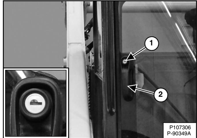
Empuje la perilla (ítem 1) y tire del mando (ítem 2) para abrir la puerta delantera. La perilla se suministra con un cerrojo (interior) [Figura 29] que asegura la puerta delantera cuando el cargador no está en uso.
