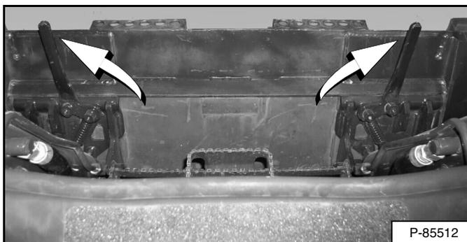
Tire de las palancas del Bob-Tach (enganche manual) hacia arriba [Figura 143] hasta que queden completamente levantadas (cuñas completamente levantadas).
