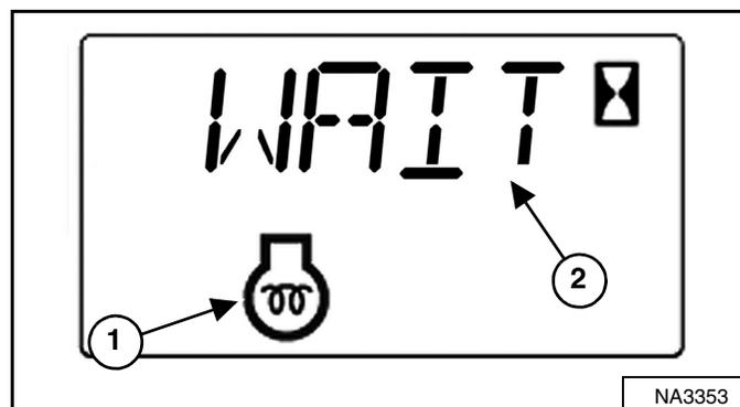
La máquina activa las bujías precalentadoras automáticamente con base en la temperatura. El ícono de precalentamiento del motor (ítem 1) y el tiempo restante del ciclo o [WAIT] (ítem 2) [Figura 124] aparece en la pantalla de datos.
