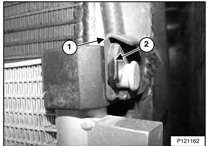
Asegúrese que el condensador del aire acondicionado está instalado en las dos mordazas [Figura 221]. (Se muestra el lado derecho).
