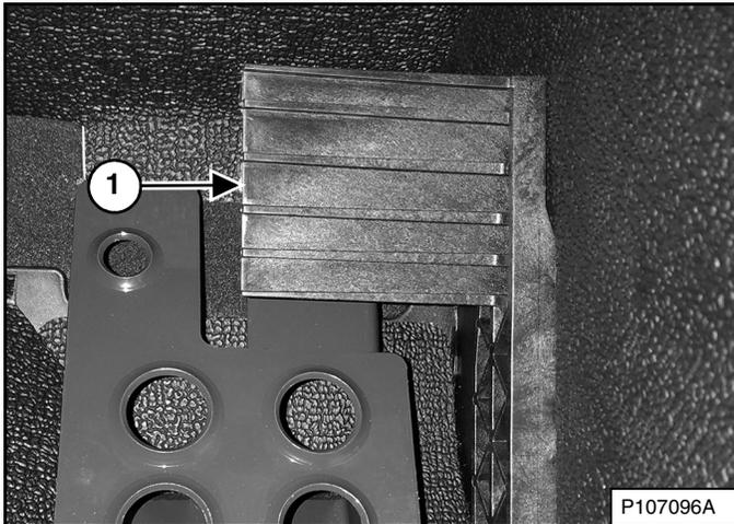
Las máquinas equipadas con SJC tienen un pedal de control (ítem 1) [Figura 40] y una perilla de control de velocidad del motor. El pedal está en el piso a mano derecha, sobre el descansapiés.
