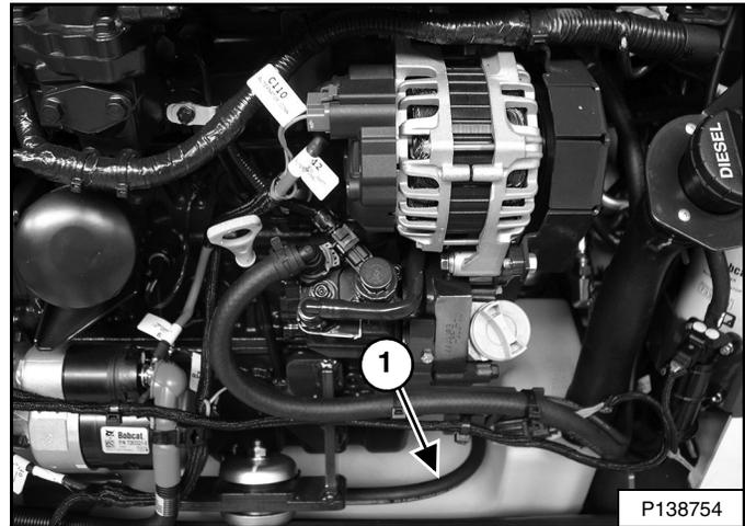
El almacenamiento de la manguera de drenaje de aceite (ítem 1) [Figura 214] está sobre el tanque de combustible.
