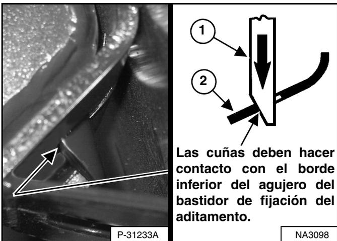
Las cuñas (ítem 1) [Figura 285] deben atravesar los agujeros en el bastidor de fijación del aditamento.
