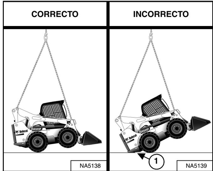
Amarre los cables o cadenas en los aros de elevación [Figura 160].
