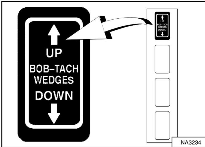
Empuje y sostenga el interruptor que “SUBE” LAS CUÑAS del BOB-TACH (en el panel de interruptores a mano derecha) [Figura 149] para asegurarse que las palancas están completamente levantadas (cuñas completamente arriba).
