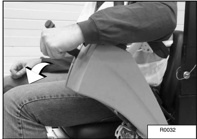
El interruptor de bloqueo del joystick desactiva las funciones de control hidráulico de los joysticks cuando la consola se sube [Figura 59].
