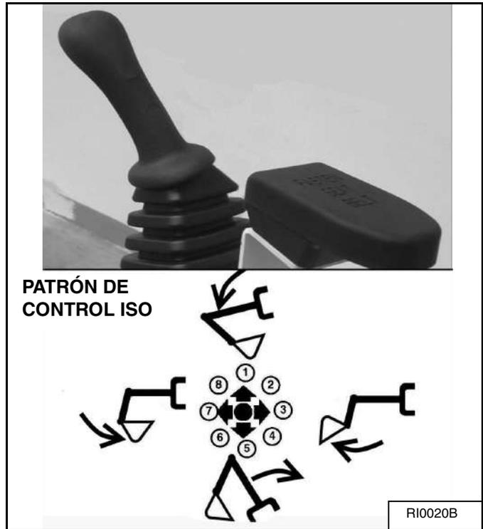
La palanca de control derecha (joystick) (ítem 1) se usa para operar la pluma y el cucharón [Figura 29].
