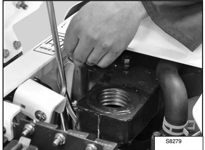
Afloje el perno superior del alternador [Figura 129].
