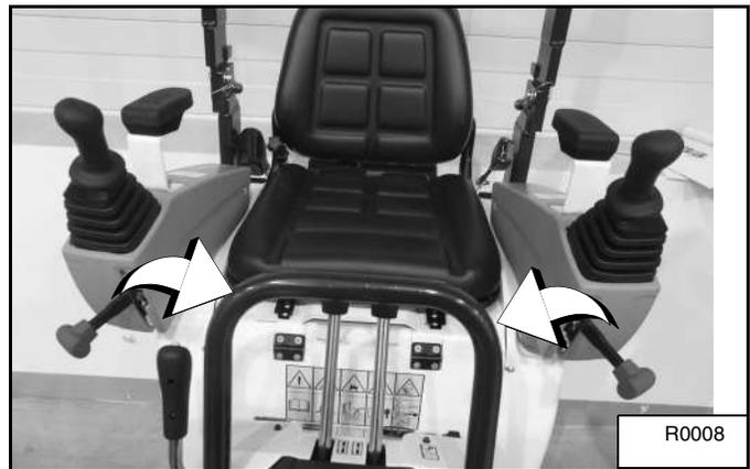
Las consolas de control se pueden acercar o alejar del operador para su comodidad [Figura 7]. Suba las consolas (ítem 1) [Figura 6] y luego muévalas hacia adentro o afuera como lo desee.
