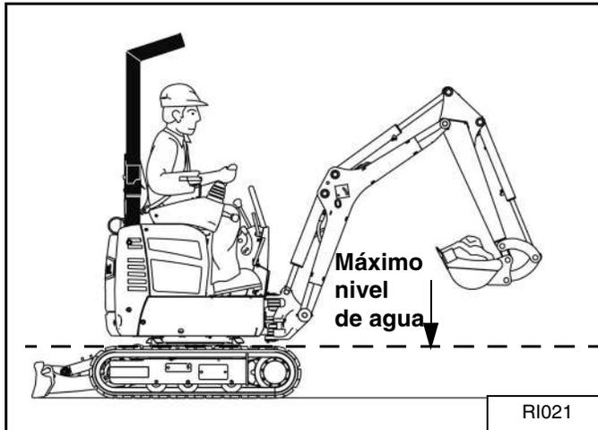
No use o sumerja la excavadora en agua a un nivel mayor de la parte inferior del círculo de giro **[Figura 69]**.
