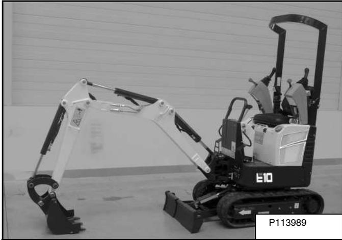
Detenga la máquina en un suelo llano. Coloque el equipo de trabajo y la pala en el suelo [Figura 55].
