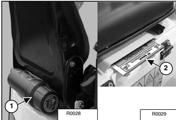
Antes de usar el equipo, lea y entienda el Manual de operación y mantenimiento (ítem 1) (ubicado dentro del recipiente de almacenamiento, debajo del asiento del operador) y el Manual del operador (ítem 2) [Figura 45].
