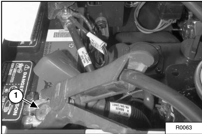
Conecte la punta del primer cable con el borne positivo (+) de la batería de refuerzo. Conecte la otra punta del mismo cable con el borne positivo (+) (ítem 1) [Figura 108] de la batería de la excavadora.
