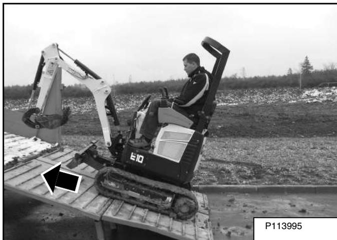
Avance la máquina sobre el vehículo de transporte **[Figura 75]**.
